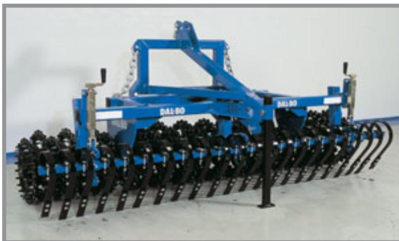
Die Arbeitstiefe des **Crossboard** kann stufenlos über Spindeln eingestellt werden. Die Einstellung des optimalen Arbeitswinkels erfolgt durch Schrauben in geführter Radiuslaufbahn.
