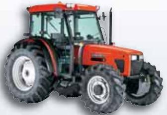
Die Compactausführung ist mit einem am Heck des Schleppers montierten Überrollbügel (zwei Pfosten) oder mit einer klimatisierten Kabine lieferbar.
