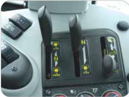
Komfortable Auswahl der Zapfwelldrehzahl und Schaltung (oben, MF 6400; unten, MF 7400)
