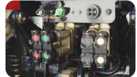
Oben: Einfacher Geräteanschluss dank gut erreichbarer Kupplungen.
