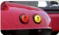
Die Zapfwelenschaltung auf dem Kotflügel erhöht Bedienkomfort und Sicherheit.
