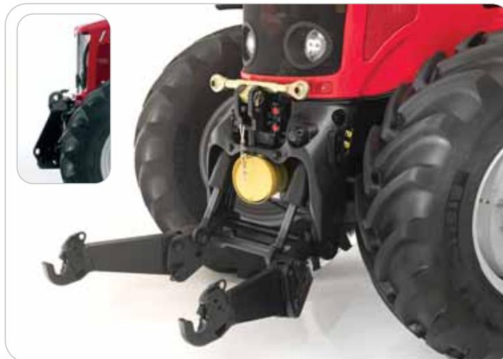
Der Kraftheber baut sehr dicht am Schlepper und ist technisch in die Traktorfront integriert für enorm hohe Stabilität für schwere Frontanbaugeräte. Der Frontkraftheber ist mit einer Zugöse, einer elektrischen Steckverbindung und mit bis zu zwei doppelwirkenden Steuerventilen ausgestattet.
