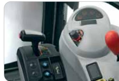
Oben: Der T-förmige Schalthebel von Dyna-6 mit einem Regler zum einfachen Einstellen der Schalt- und Wendegeschwindigkeit.
