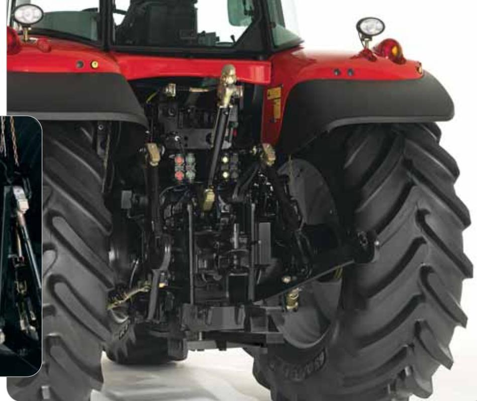
Die ATC unterliegt nicht der Transportsperre und kann manuell oder automatisch gesteuert werden. Sie ist mit dem EHR-Schalter für Heben/Senken gekoppelt und wird bei Ausheben des Geräts aktiviert und beim Absenken deaktiviert.
