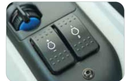
Mit „+/-“ kann die Motordrehzahl eingestellt werden. Mit dem Schalter A/B lassen sich zwei Drehzahlen speichern und abrufen.
