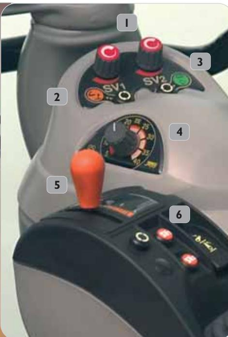
Links: SV1/SV2-Regler für Tempomat (1), Pedal- oder Hebelmoduseinstellung (2) und Taster für Fahrbereich (3) – alles bequem an einer Stelle
