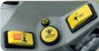
Die Bedienelemente für Zapfwelldrehzahl, Schaltung und Automatikfunktion sind gut erreichbar und einfach zu betätigen.
