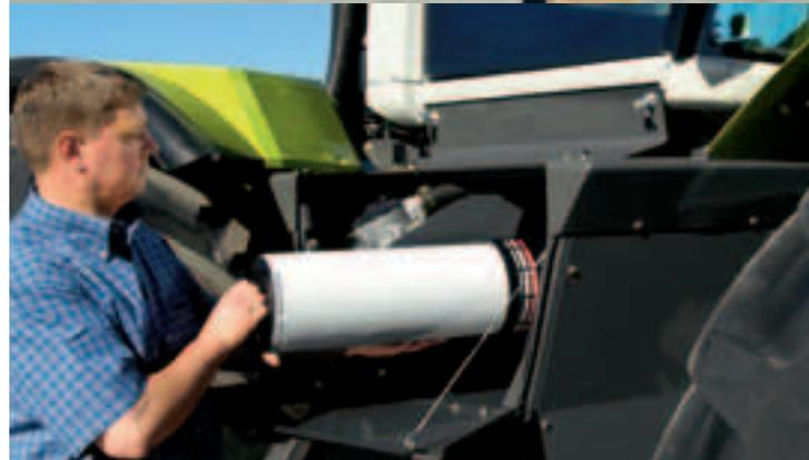
Schnell, einfach, problemlos: Luftfilterwechsel im XERION.
