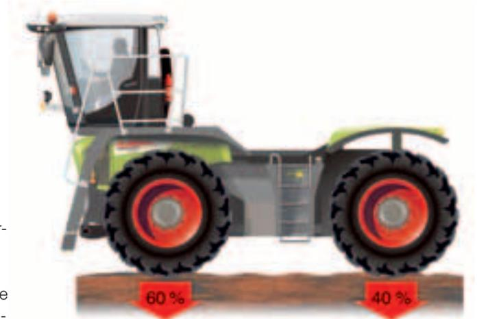
Lastverteilung bei leerer Maschine. Mit Auflieger bei mittlerer Kugelkupplung ist eine dynamische Lastverteilung von 50 % vorn und 50 % hinten realisierbar.
