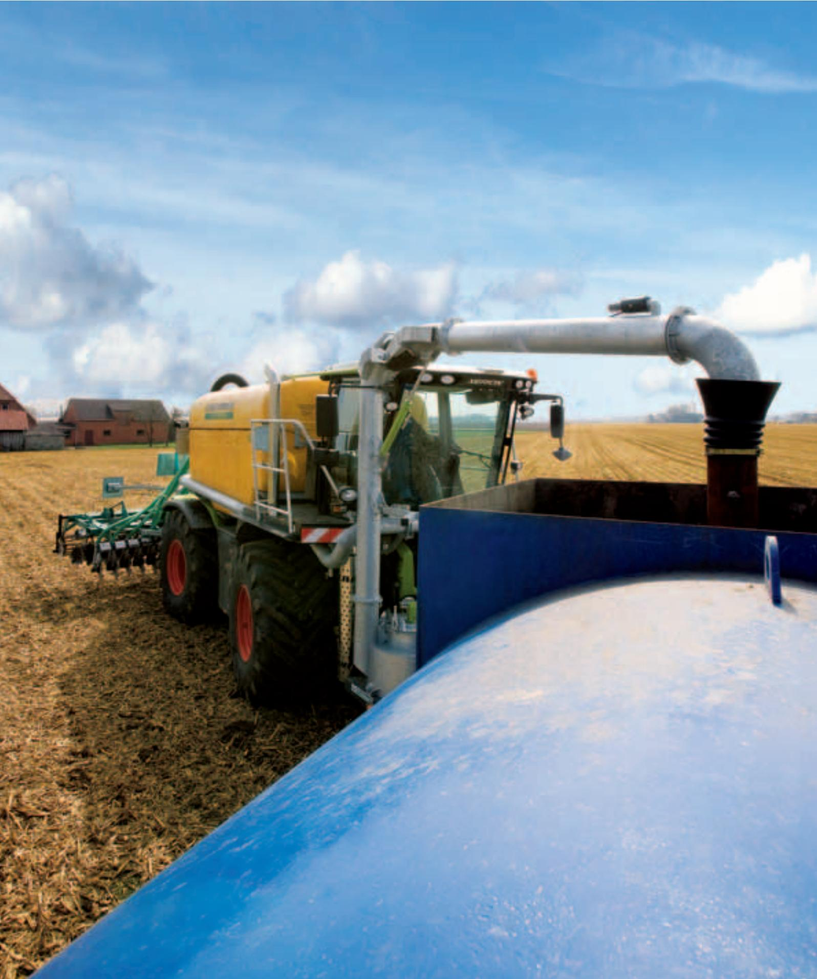
Gülle ansaugen mit geringer Motordrehzahl bei gleichzeitig maximaler Förderleistung; hier: 14 m<sup>3</sup> in weniger als 2 Minuten bei ca. 1.400 U/min Motordrehzahl.
