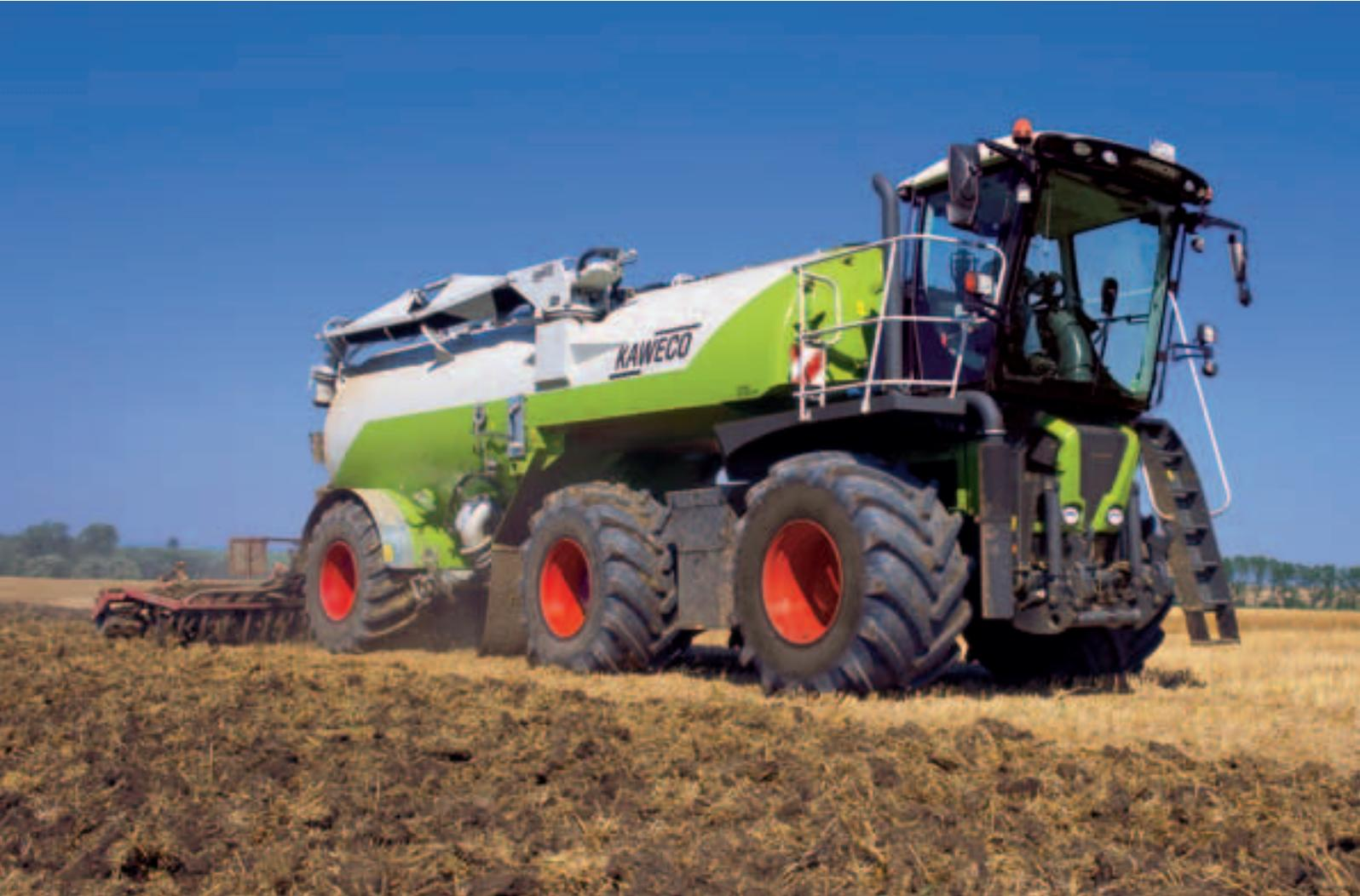
Vorn der XERION 3300 SADDLE TRAC, hinten ein 26-m<sup>3</sup>-Gülleauf-
